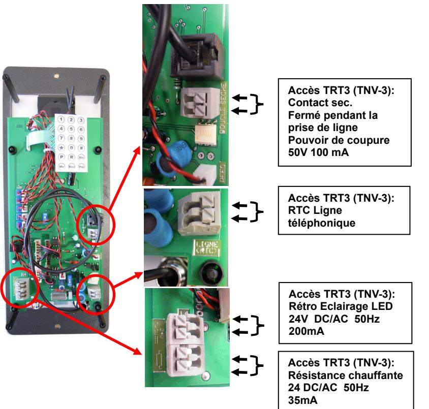
Au cas où l'on souhaiterait utiliser 2 ou 3 fonctions simultanément, il suffit de prévoir une seule alimentation dont les caractéristiques et les raccordements sont indiqués ci-dessous.
