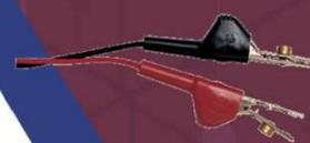
**Cordon avec pinces perforantes** compatible avec les combinés Série 4 et Série 6, les pinces situées en extrémité évitent d'avoir à dénuder le câble en perforant localement la gaine pour atteindre plus facilement l'âme conductrice
